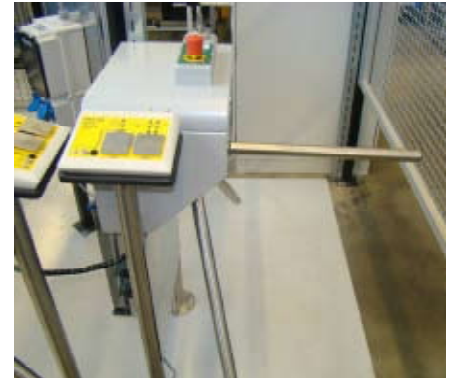
Das System prüft die Personenableitwiderstände der Personen mit ESD-Überschuhen beim Zutritt nach geltender internationaler ESD-Norm.
