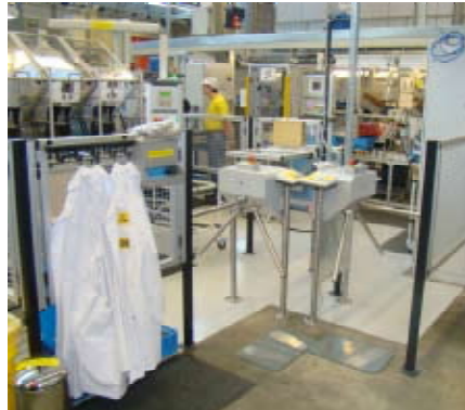
Im Stammwerk Bühl schützt ein ESD-Zutrittskontrollsystem die Fertigungsbereiche, die frei von elektrostatischen Entladungen sein müssen.
