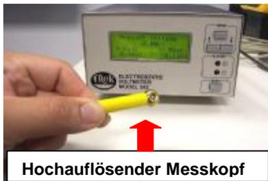
**Bild 10** – TREK Voltmeter 542-1-CE
