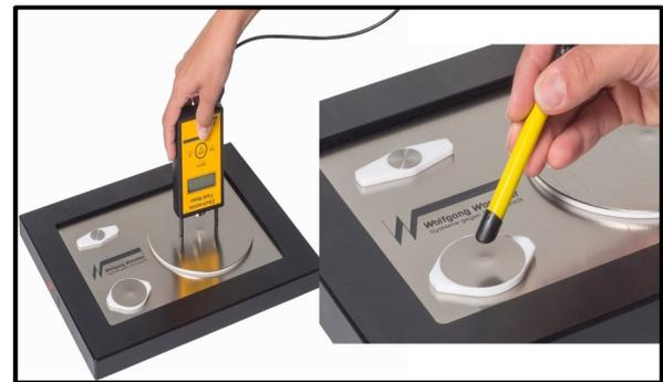
Abbildung 6: Messung mit EFM und ESVM Typ 01
