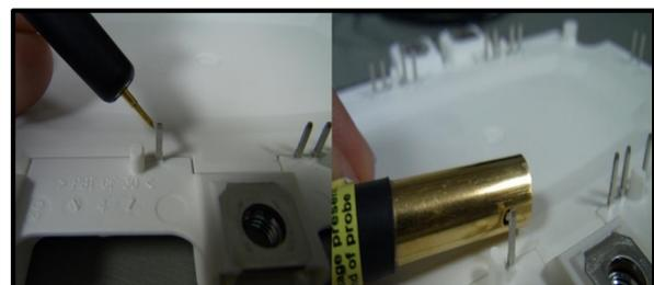
Abbildung 13: Messung an den Kontaktpins eines IGBT-Moduls mit Kontaktvoltmeter (ESVM Typ 03, links) und ESVM Typ 02 (rechts)
