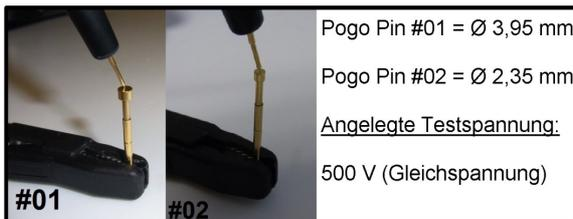
Abbildung 10: Messung an Pogo-Pins
