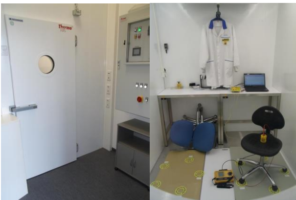
Abbildung 1: Begehbare Klimakammer (links: Außenansicht, rechts: Innenansicht)
