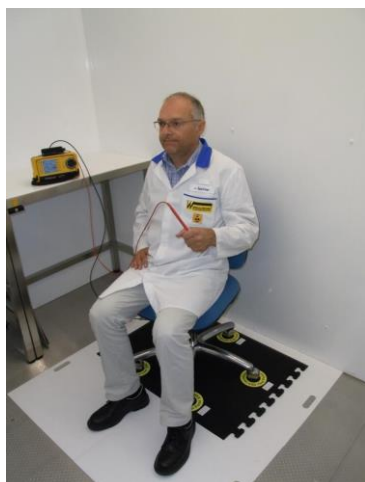
Abbildung 7: Messung der Ableitwiderstände R_{gSystem} von einer sitzenden Person mit getragenen Arbeitsmantel über einen Drehstuhl zu einem Bodensystem. Die sitzende Person trägt dabei isolierende Straßenschuhe, die beide auf der isolierenden Teflon-Platte abgestellt sind.
