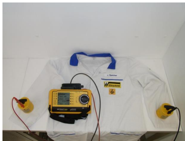
Abbildung 4: Messung der Punkt-zu-Punkt-Widerstände R_{p-p} (hier als Beispiel: Typ „B-2“).
