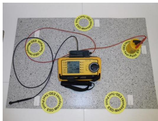
Abbildung 2: Jeweils 5 definierte Messpunkte zur Messung der Ableitwiderstände R_{gp} (hier als Beispiel: PVC-Belag, Nr. 1).
