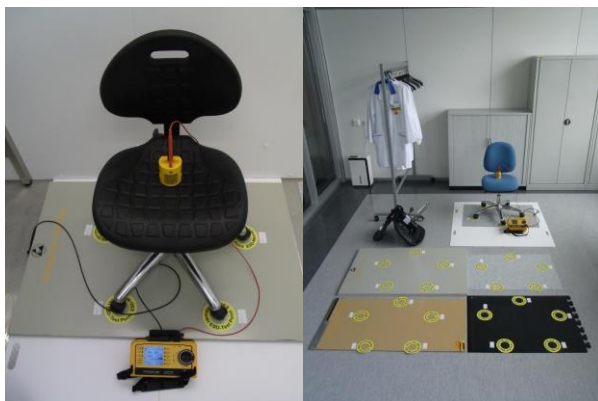
Abbildung 6: links: Messung des Stuhltyps „DS-2“ auf Bodenmuster „BS-5“ in der begehbaren Klimakammer. rechts: Prüfbereich im Labor mit Stuhltyp „DS-1“ und allen Bodenmustern.
