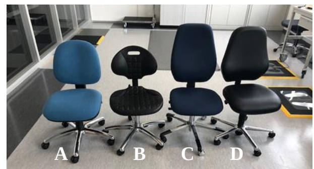
Abbildung 4: ESD-Drehstühle für den „Chair-Walking-Test“ (A bis D von links nach rechts).
